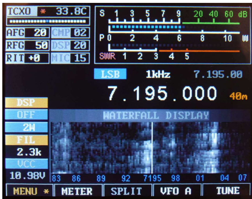
Fig.4: Ein typisches Wasserfall-Display im Modus „Magnify“, das \pm 12 kHz (24 kHz) eines Bandsegments zeigt. Ist der Modus „Magnify“ nicht aktiv, sind \pm 24 kHz (48 kHz) eines Bands sichtbar.
